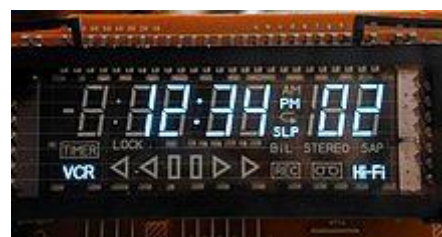
Afficheur fluorescent classique utilisé dans un magnéscope.
