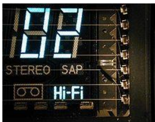
Gros plan d'un afficheur fluorescent sur lequel on note les filaments tendus par les ressorts métalliques visibles à droite.
