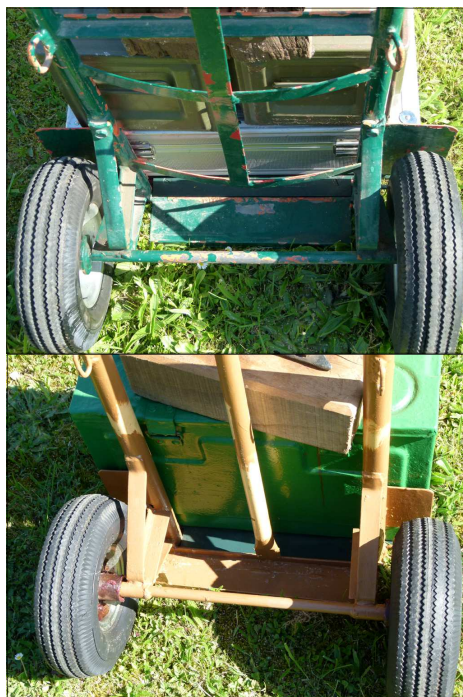
Supports au dessus des essieux En dessous, supports pour recevoir Antennes, mâts, etc...
