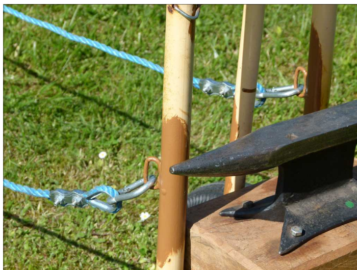
Accrochage des traits sur les points d'ancrage soudés sur les châssis des diables
