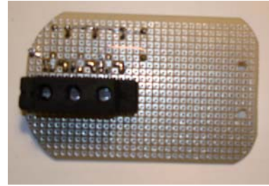
Photo 5 : Le CI 2 support de LDR avec la petite pièce de bois guidant les LDR
